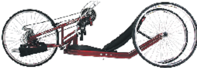
Самостоятельные трехколесные конструкции — полноценные хендбайки, приводимые в движение также руками, но позволяющие приложить несравнимо большее усилие
